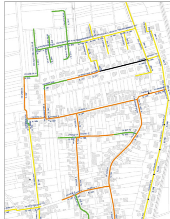
Restnutzungsdauer von Trinkwasserleitungen
